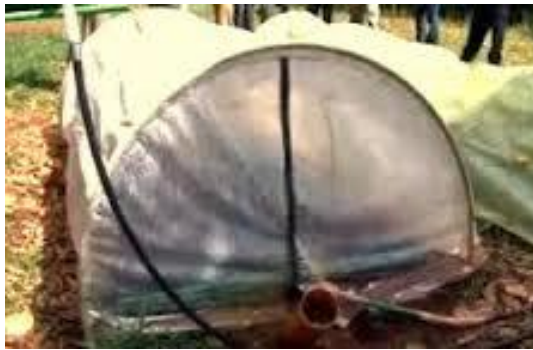
Gambar 2.8. Digester sederhana dari bahan plastik
