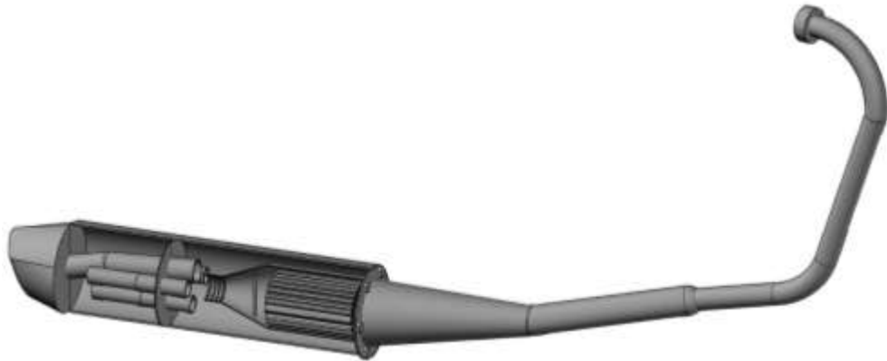
Gambar 6. Metallic catalytic converter di dalam knalpot eksperimen
