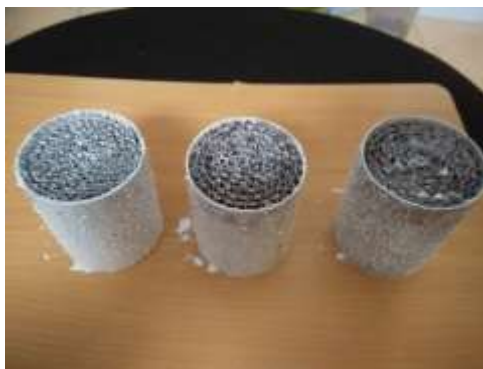
Gambar 15. Catalytic converter titanium dioksida variasi Cu lekukan 2, Cu lekukan 3, Cu lekukan 4 mm + 150 gr TiO 2
