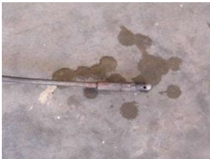
Gambar 24. Air yang keluar dari gas probe setelah pengujian emisi Catalytic converter titanium dioksida variasi Cu lekukan 2, Cu lekukan 3, Cu lekukan 4 mm + 150 gr TiO 2
