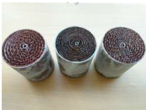
Gambar 13. Catalytic converter titanium dioksida variasi Cu lekukan 2, Cu lekukan 3, Cu lekukan 4 mm + 50 gr TiO 2
