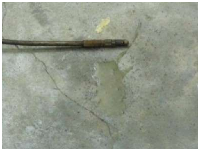
Gambar 22. Air yang keluar dari gas probe setelah pengujian emisi Catalytic converter titanium dioksida variasi Cu lekukan 2, Cu lekukan 3, Cu lekukan 4 mm + 50 gr TiO 2
