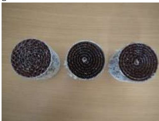
Gambar 14. Catalytic converter titanium dioksida variasi Cu lekukan 2, Cu lekukan 3, Cu lekukan 4 mm + 100 gr TiO 2
