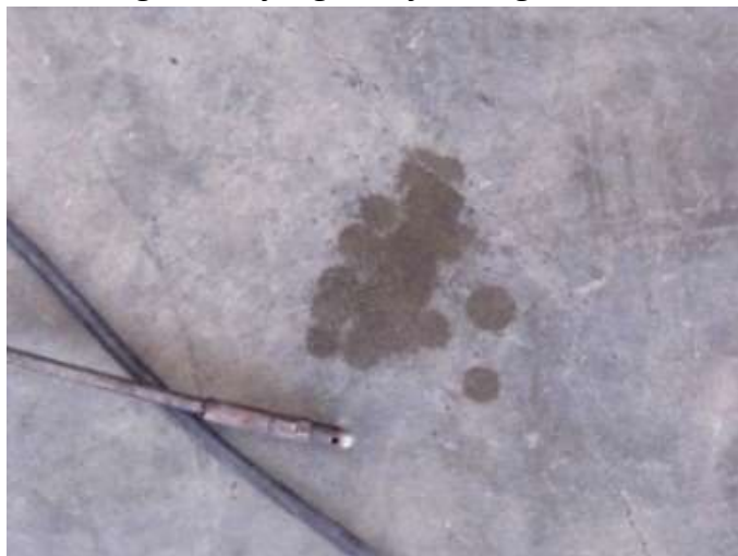
Gambar 23. Air yang keluar dari gas probe setelah pengujian emisi Catalytic converter titanium dioksida variasi Cu lekukan 2, Cu lekukan 3, Cu lekukan 4 mm + 100 gr TiO 2
