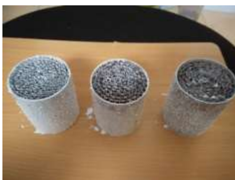
Gambar 15. Catalytic converter titanium dioksida variasi Cu lekukan 2, Cu lekukan 3, Cu lekukan 4 mm + 300 gr TiO 2
