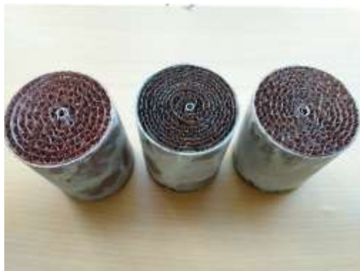
Gambar 13. Catalytic converter titanium dioksida variasi Cu lekukan 2, Cu lekukan 3, Cu lekukan 4 mm + 200 gr TiO 2
