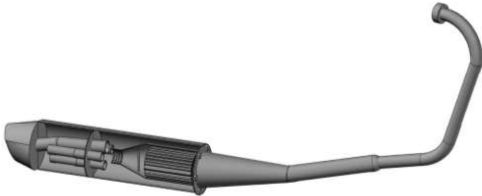
Gambar 6. Metallic catalytic converter di dalam knalpot eksperimen
