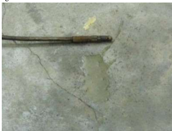
Gambar 22. Air yang keluar dari gas probe setelah pengujian emisi Catalytic converter titanium dioksida variasi Cu lekukan 2, Cu lekukan 3, Cu lekukan 4 mm + 200 gr TiO 2
