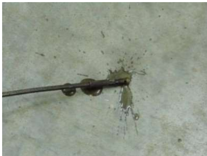
Gambar 21. Air yang keluar dari gas probe setelah pengujian emisi pada knalpot standar dengan MCC Pt & Rh dan tanpa MCC Pt & Rh
