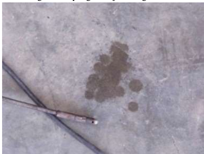
Gambar 23. Air yang keluar dari gas probe setelah pengujian emisi Catalytic converter titanium dioksida variasi Cu lekukan 2, Cu lekukan 3, Cu lekukan 4 mm + 250 gr TiO 2
