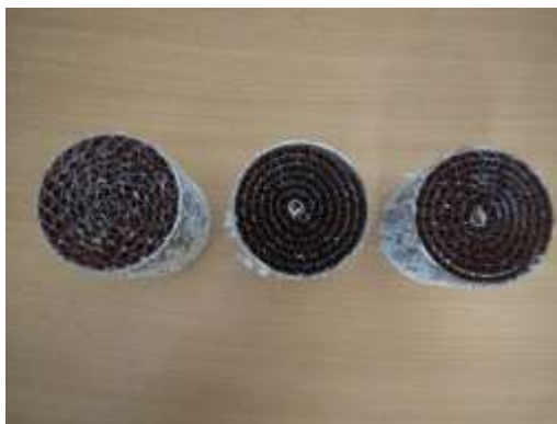
Gambar 14. Catalytic converter titanium dioksida variasi Cu lekukan 2, Cu lekukan 3, Cu lekukan 4 mm + 250 gr TiO 2
