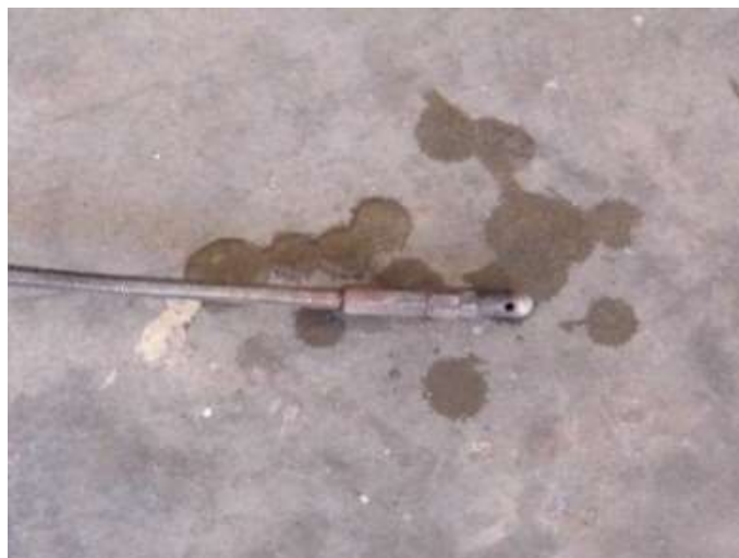
Gambar 24. Air yang keluar dari gas probe setelah pengujian emisi Catalytic converter titanium dioksida variasi Cu lekukan 2, Cu lekukan 3, Cu lekukan 4 mm + 300 gr TiO 2
